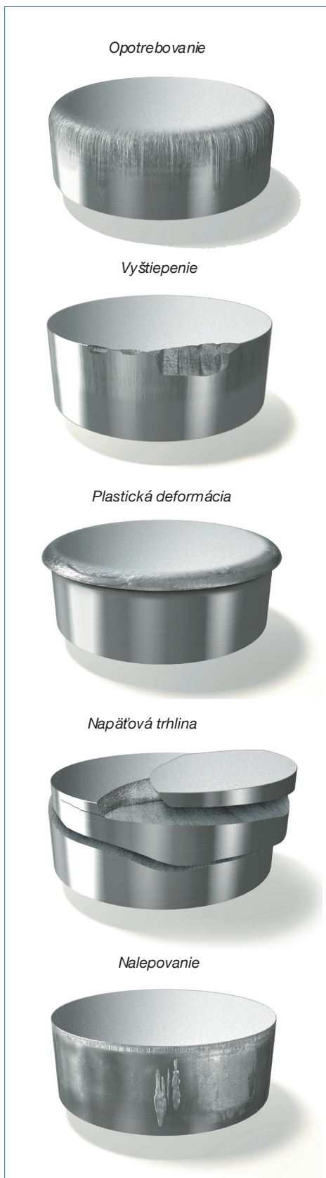
Obrázok 3. Najčastejšie príčiny zlyhania lisovacích nástrojov.
