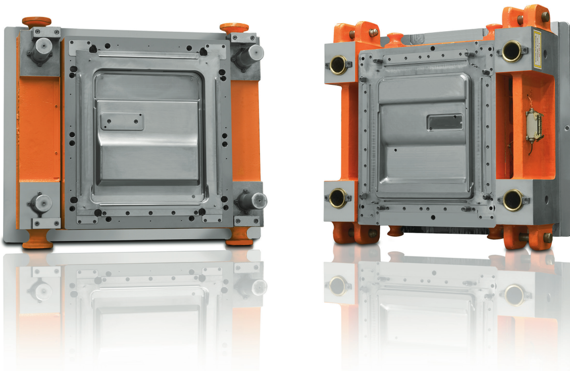
Nástroj z monobloku Uddeholm Vancron SuperClean pre lisovanie dielu umývačky riadu.
