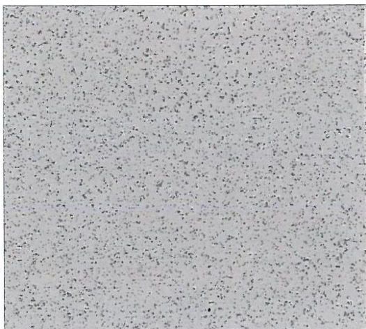
UDDEHOLM VANAX SuperClean - obsahuje približne 13% častíc tvrdej fázy. Po kalení z 1080°C, zmrazovaní (DC) a popustení na 200°C/2 x 2h, 60HRC
