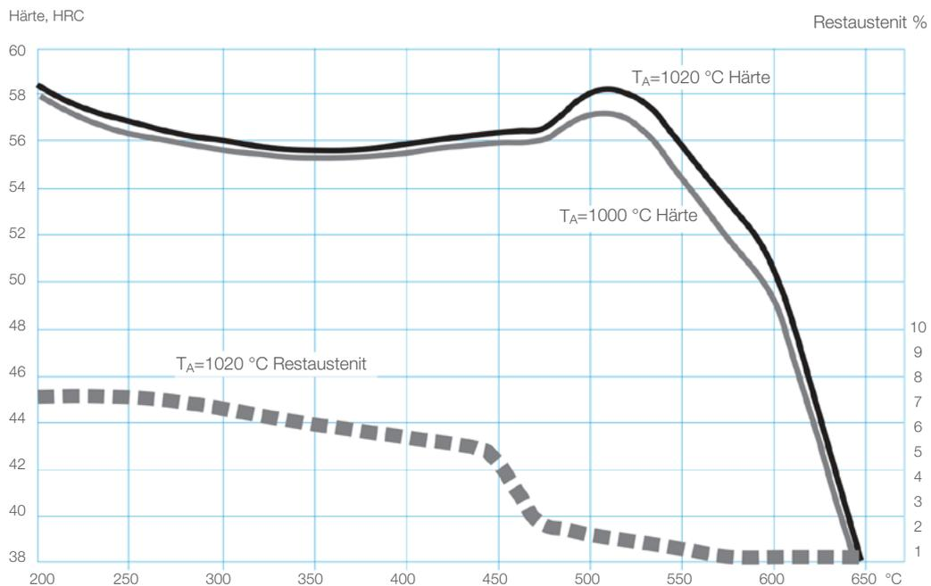
Dieses Anlassschaubild wurde nach der Wärmebehandlung von Proben der Größe 15 x 15 x 40 mm, abgekühlt durch Gebläseluft/Umluft, erstellt. In Abhängigkeit von Faktoren wie Werkzeuggröße und Wärmebehandlungsparametern können niedrigere Härten erzielt werden.
