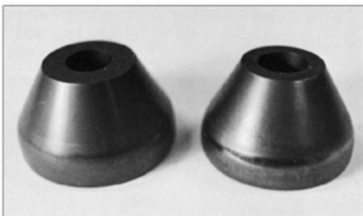
PVD-beschichtete Werkzeuge in Uddeholm Vanadis 23 SuperClean für die Kaltumformung von Röhren.
