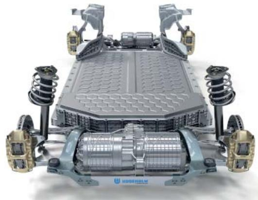
E-mobility - L'illustrazione mostra per es. scatola della batteria, alloggiamento del motore elettrico e parti strutturali su un'auto EV.
