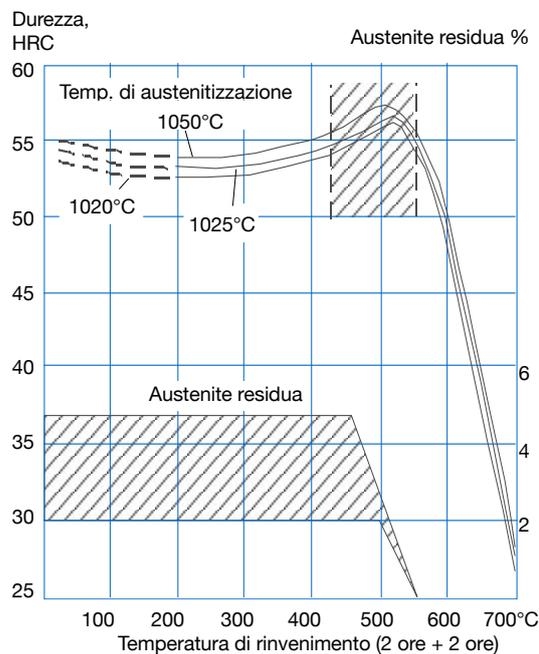
Le curve di tempra sopra riportate sono state ottenute dopo il trattamento termico di campioni di dimensioni 15 x 15 x 40 mm, con raffreddamento in aria forzata. Si può prevedere una durezza inferiore dopo il trattamento termico di utensili e matrici a causa di fattori quali le dimensioni effettive dell'utensile e i parametri di trattamento termico.
