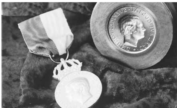
Applicazione di stampaggio a freddo dove Uddeholm Calmax potrebbe essere una buona scelta per lo stampo.
