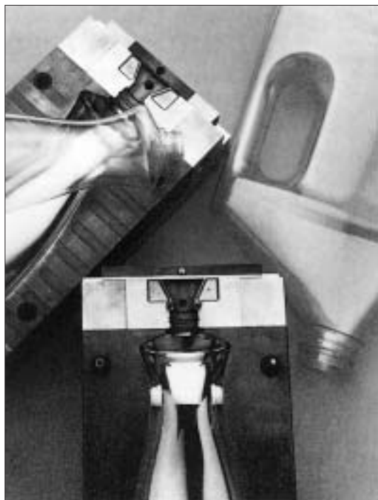
Due metà di uno stampo per soffiaggio in Moldmax HH.
