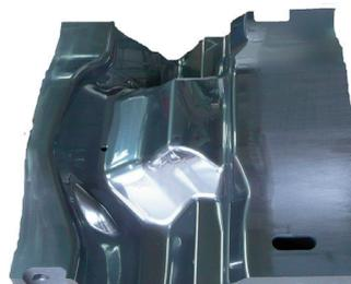
Matriz fabricada con 1.2379, peso aprox. 700 kg; pulido y con recubrimiento DUPLEX-TIGRAL de 5 µm
