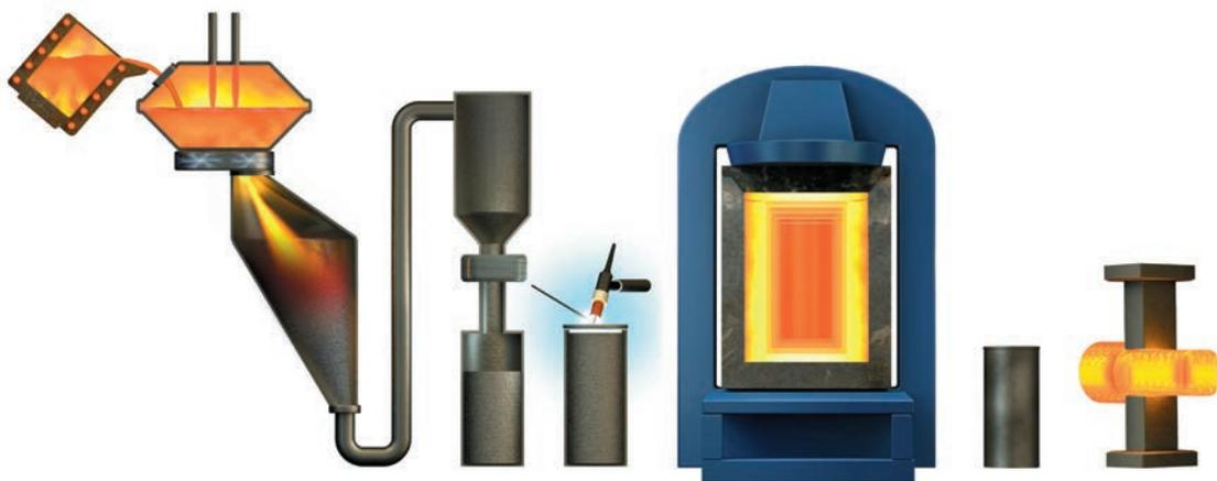
*Figure 6. Representación esquemática del proceso pulvimetalúrgico (PM) de producción de acero para herramientas.*
