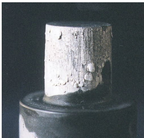
Problemas causados por adherencias (soldaduras) en un noyo.
