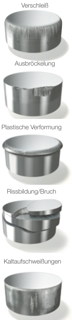
Die häufigsten Ausfallmechanismen bei Kaltarbeitswerkzeugen.
